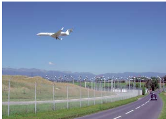
Le « sol artificiel » (balises) guide les avions à l'atterrissage.
